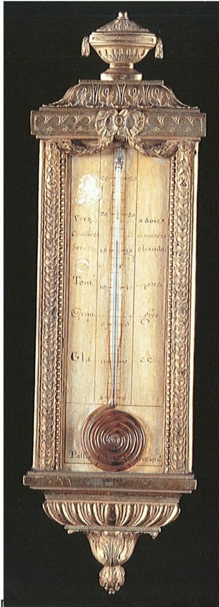
Thermomètre à alcool, à réservoir en spirale, de Passemant, datant de 1750.
