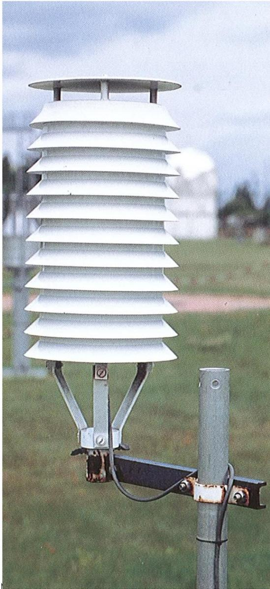
L'abri miniature est aujourd'hui utilisé dans nos stations automatiques pour accueillir les sondes thermométriques et hygrométriques.
